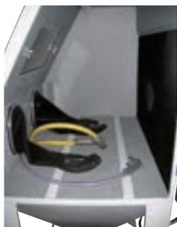
Pistolet de sablage et air comprimé
